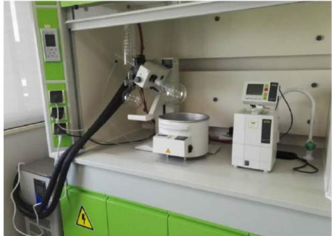
具有真空控制及冷却装置的旋转蒸发仪
